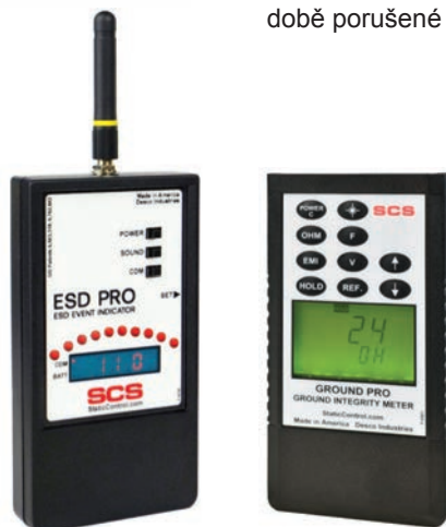
Obr. 2 Jednoduchý přístroj k detekci ESD událostí v čase. Přístroj detekuje ESD události v čase například na SMT lince
