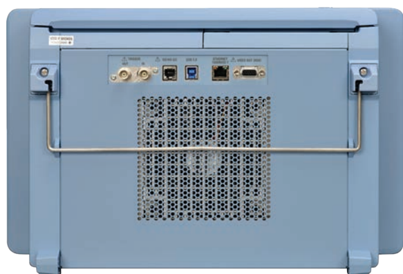
Obr. 2 Z pohledu rozhraní na nás čeká externí spouštění, výstup Go / No-Go, USB, ethernet, video výstup (RGB), vývody pro zajištění synchronního provozu (DLMSync), napájení sond a také GPIB. Logické vstupy, včetně jejich dalšího rozšiřování, vyřešíte přímo na čelním panelu [4]
