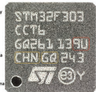
Obr. 9 Příklad popisu pouzdra s vyznačením zhotovitele plátku a země s lokalitou dokončení
