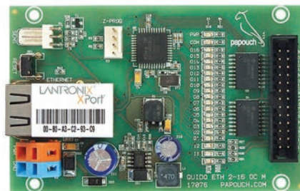
Obr. 2 Modul Quido s 2 vstupy, 16 výstupy (OC) a rozhraním ethernet. Lze dokoupit svorkovnici.
