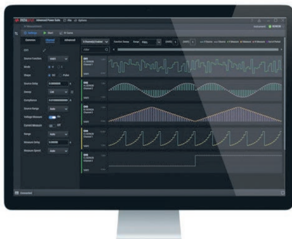
Obr. 3 Software s označením „PW9251A PathWave IV Curve Measurement“ pomůže při snadném nastavení SMU značky Keysight a také příslušném synchronním měření volt-ampérových charakteristik, které nebude podmíněno nutností cokoli programovat [4]
