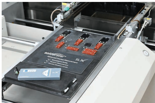
Obr. 1 Reflow Shuttle měří důležité parametry při ověřování pájecího procesu
