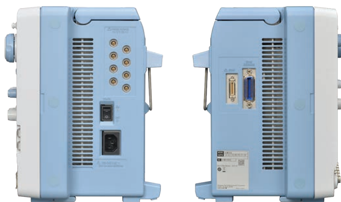
Obr. 2 Z pohledu rozhraní na nás čeká externí spouštění, výstup Go / No-Go, USB, ethernet, video výstup (RGB), vývody pro zajištění synchronního provozu (DLMSync), napájení sond a také GPIB. Logické vstupy, včetně jejich dalšího rozšiřování, vyřešíte přímo na čelním panelu [4]
