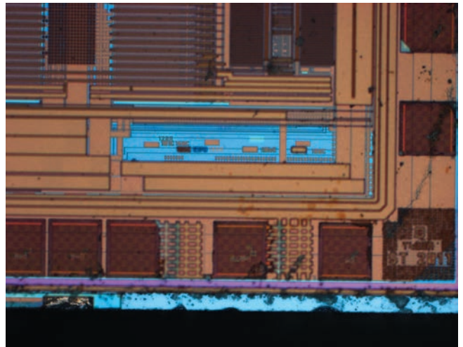
Obr. 14 Snímek oblasti s logem a číselnými kódy litografických vrstev
