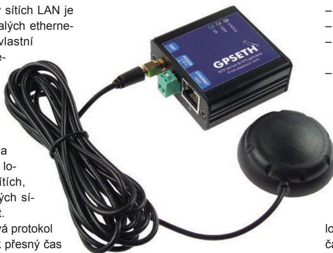
Obr. 1 Malý časový server GPSETH s anténou
