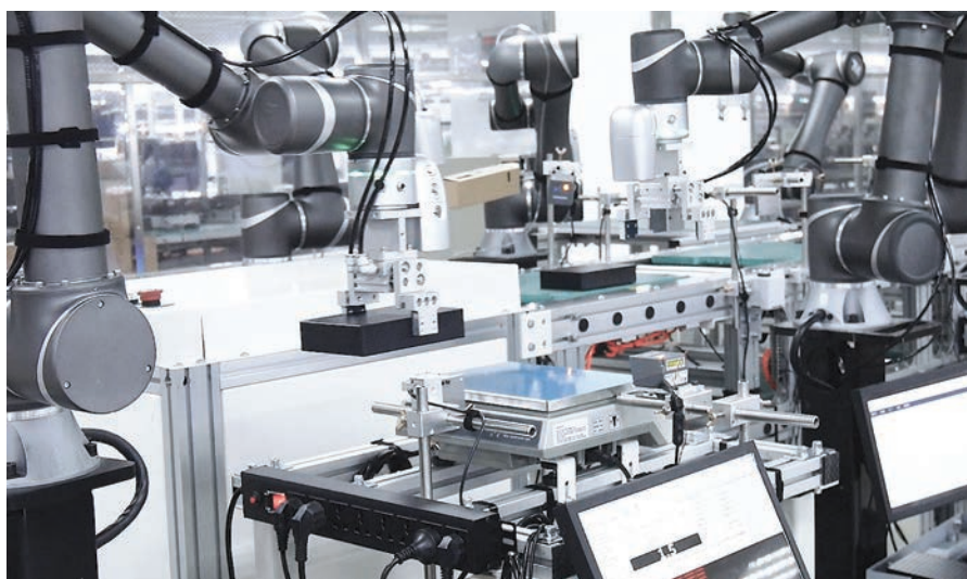
Příklad použití robota Techman v průmyslové aplikaci pick & place
