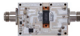
Obr. 6 „RF Energy Pallet“ RFEP24-300 od NXP
