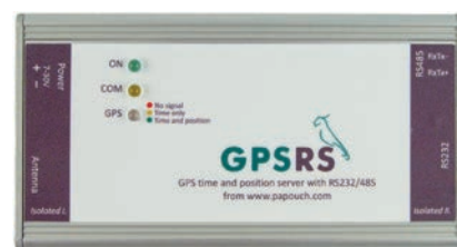
Obr. 3 Modul GPSRS umožňuje číst přesný čas protokolem Modbus RTU
