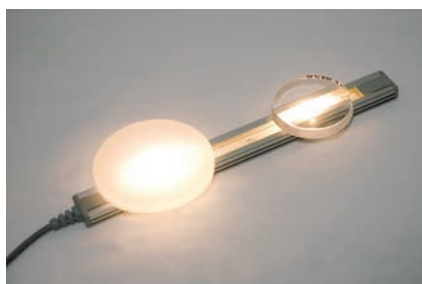
Obr. 2 Srovnání difuzní (UR5635) a čiré zalévací hmoty (UR5634) u LED
